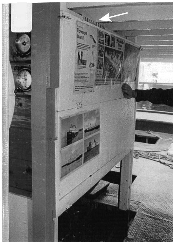
Photo 12. Armoire de rangement des gilets de sauvetage dans le capotage du moteur avec la porte en position fermée portant l'écriteau LIFEJACKETS [gilets de sauvetage] (flèche) et des affiches fixées à la porte.
