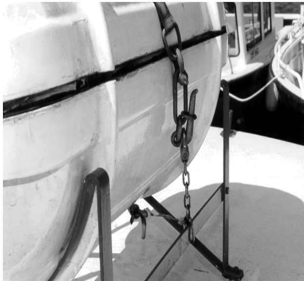
Photo 13. Bosse Senhouse à déclenchement manuel qui retenait le radeau de sauvetage gonflable dans le berceau placé sur le toit de la superstructure
