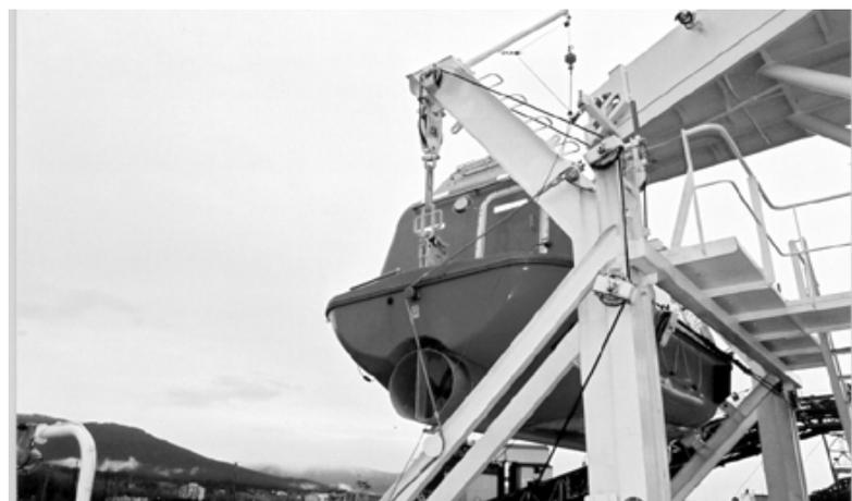
**Photo 6** – Vue arrière de l'embarcation de sauvetage montrant le bossoir, la disposition des saisines sur les bollards, l'anneau de suspension, le croc et le panneau
