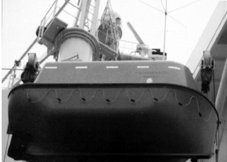
**Photo 1** – Têtes du bossoir et côté extérieur de l'embarcation de sauvetage
