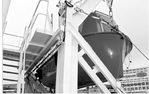
**Photo 8** – Vue avant de l'embarcation de sauvetage montrant les bossoir, la disposition des saisines sur les bollards, l'anneau de suspension, le croc et le panneau
