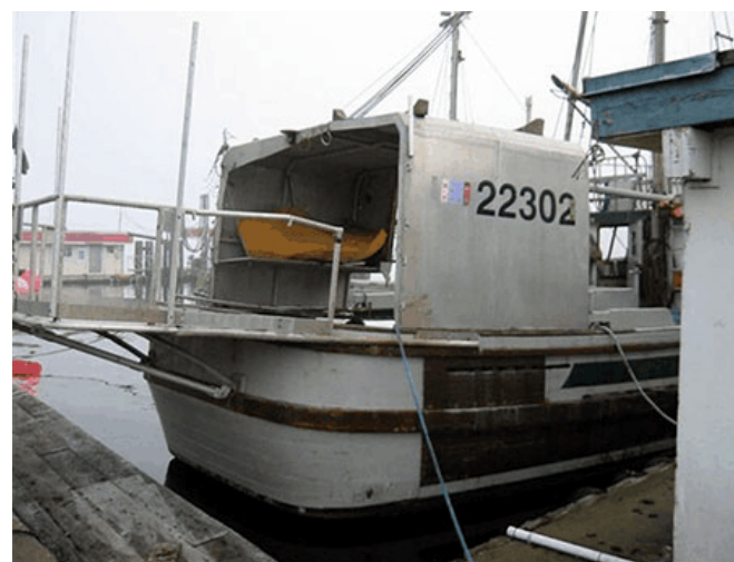
Photo 5. Vue arrière de la rallonge double et de l'espace réservé aux appâts
