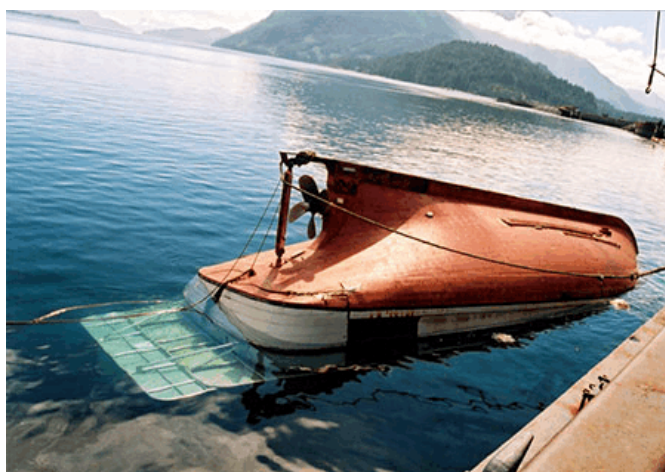
Photo 3. Le Fritzi-Ann chaviré amarré à quai. À noter les rallonges de pont submergées.
