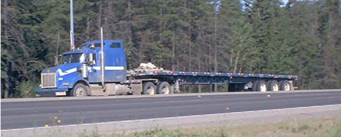
Semi-remorque à six essieux en groupe tridem (plateau)
