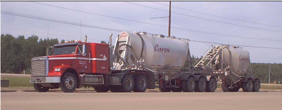
Train double de type B à huit essieux (citerne à pulvérulents)
