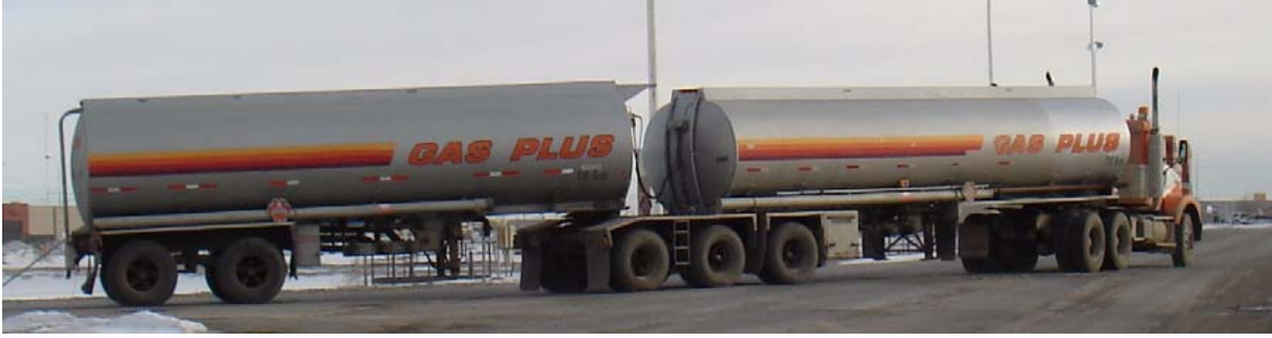
Train double de type B à huit essieux (citerne à liquide)
