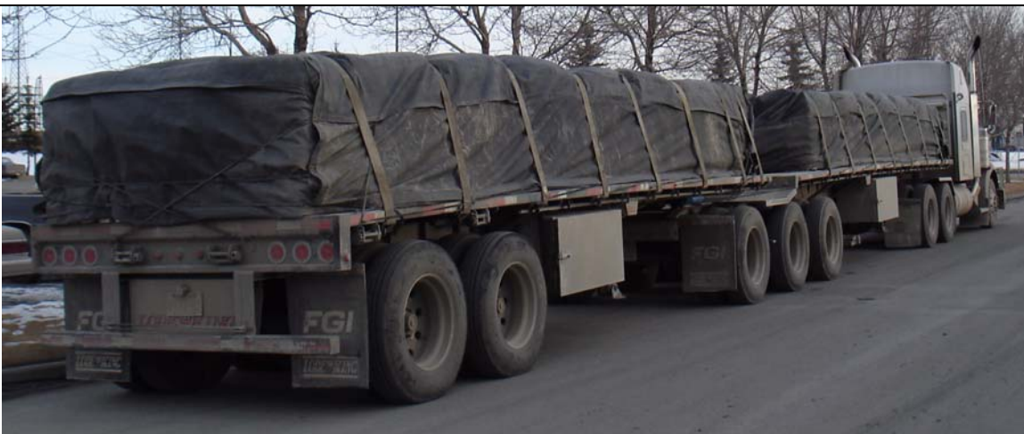
Train double de type B à huit essieux (plateau)
