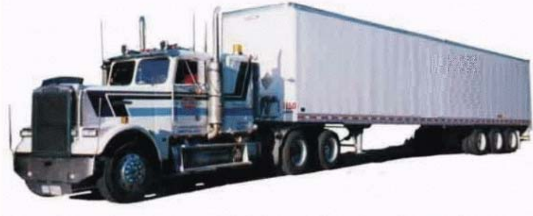
Semi-remorque à six essieux en groupe tridem (fourgon)
