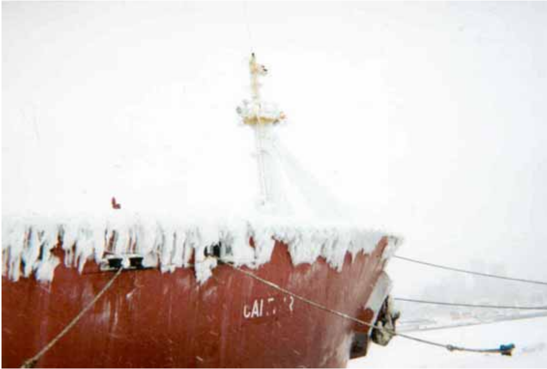
Figures 5.3A – Cas sévère d’accumulation de glace sur l’avant du navire
