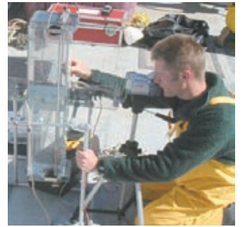
Tony Walker mesurant la taille des particules et la vitesse de sédimentation de déchets biologiques de moules (fèces et pseudofèces) à proximité de filières de moules, à l'aide de la vidéographie et d'une chambre de sédimentation. Cette chambre de sédimentation a servi à mesurer la dynamique des dépôts biologiques au Nouveau-Brunswick, à l'Île-du-Prince-Édouard et au Québec.
