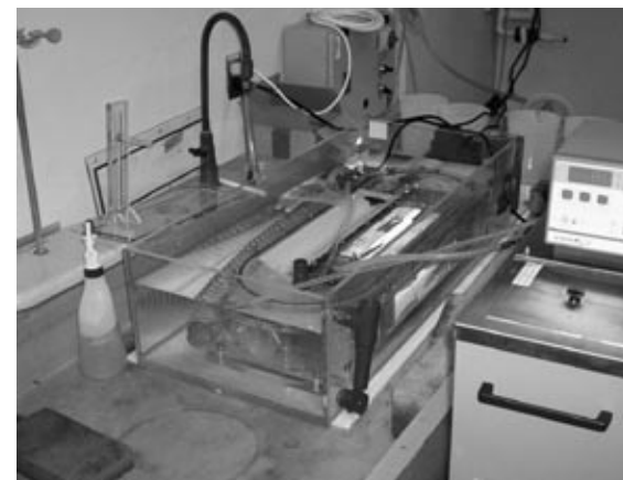
Tunnel de nage pour mesurer les vitesses maximales de nage ( U_{crit} ) des saumons quinnats juvéniles.
