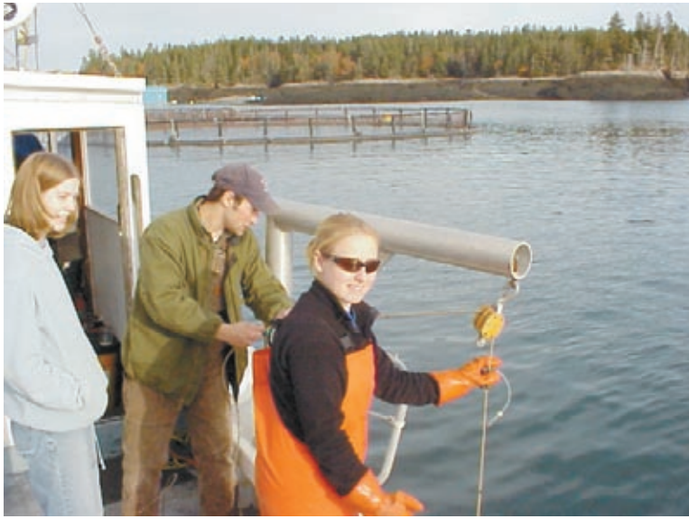
Terralynn Lander prélevant des échantillons d'eau pour analyser le degré d'enrichissement de l'eau par des résidus organiques.
