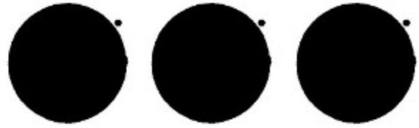
Fig. 5: Signe spécial international pour les ouvrages et installations contenant des forces dangereuses
