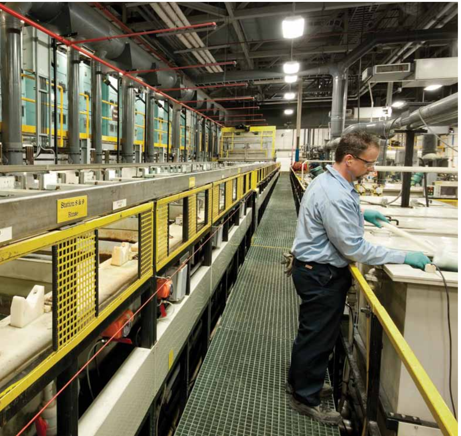
La chaîne ultramoderne de placage multicouche de la Monnaie produit les pièces de circulation de la plus haute qualité au monde.
