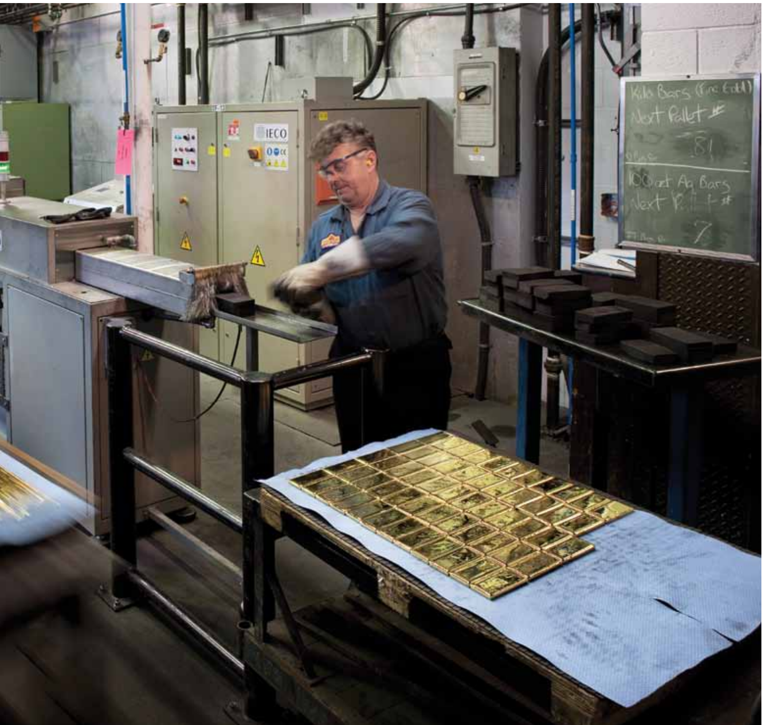
En service à Ottawa depuis juillet 2009, un nouveau four à haut débit produit des lingots d'argent de 100 onces et des lingots d'or de un kilo.
