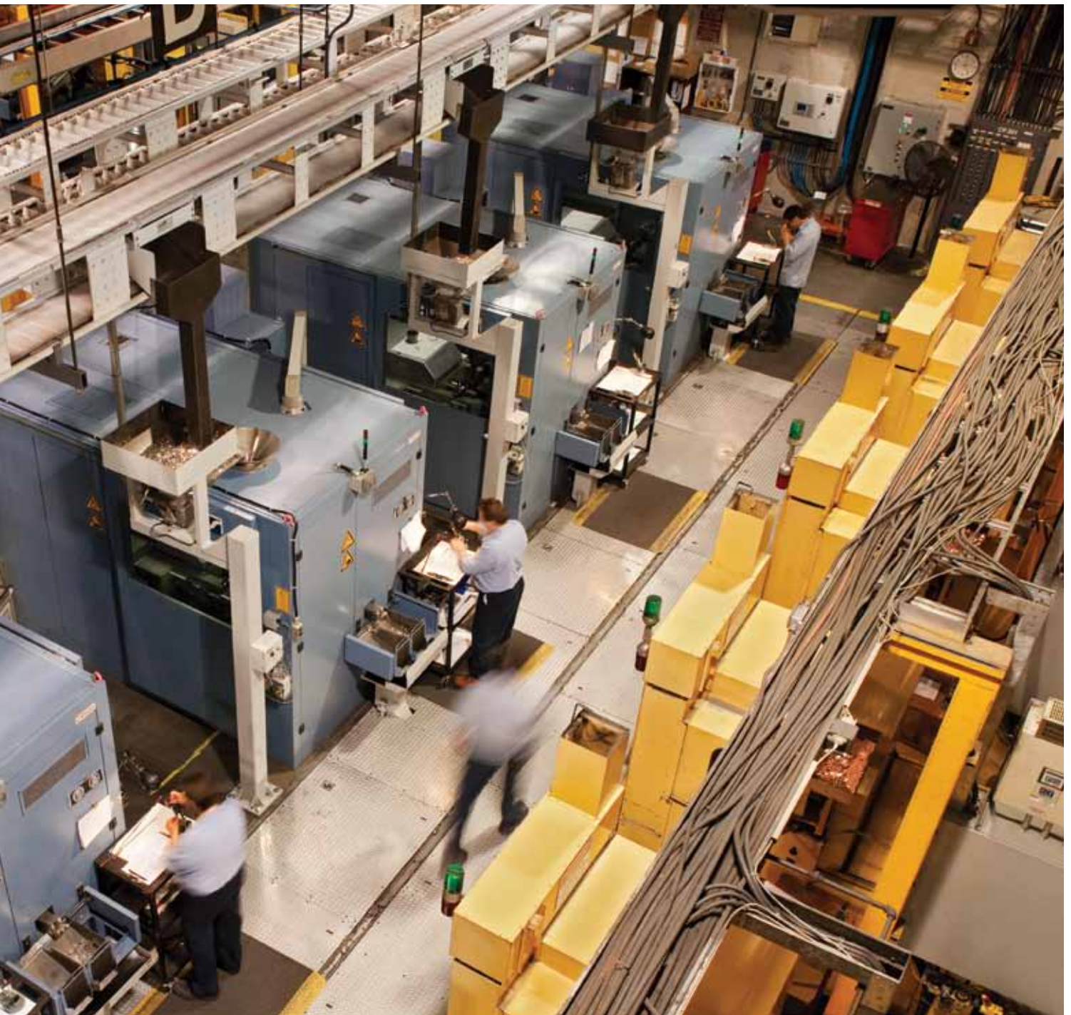
Plus de 40 presses ultra-rapides peuvent frapper quotidiennement jusqu'à 20 millions de pièces de circulation à Winnipeg.
