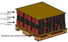
Lorsqu'on empile du courrier avec dos en rangées irrégulières, on doit placer des doublures en carton au début de chaque nouvelle rangée pour assurer la stabilité de la charge, peu importe si des palettes ou des monoteneurs sont utilisés. Alternez l'orientation des dos pour chaque rangée, en d'autres mots, tournez les livres de 180 degrés plutôt que de 90 degrés comme pour les autres types de courrier.
