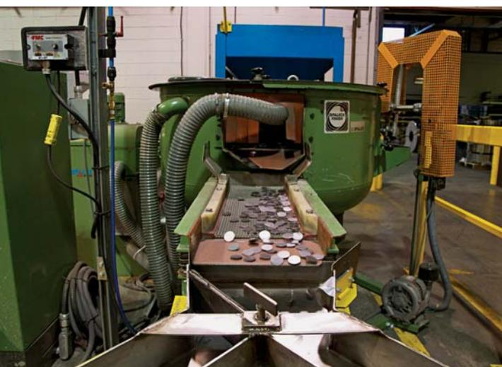
Les poinçonneuses percent des flans à partir des bobines (À L'EXTRÊME GAUCHE). Les flans circulent dans des machines remplies de rafles de maïs, ce qui a pour effet de les dégraisser; ils sont ébarbés, puis on forme leur rebord pour augmenter leur résistance. Ils passent ensuite sur une bande transporteuse où on les inspecte (À GAUCHE). Les feuilles percées sont pesées et refondues avant d'être reformées en nouvelles bobines.
