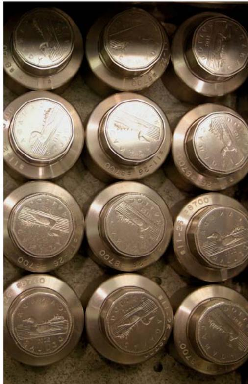
La production d'une pièce de qualité exige un poinçon bien apprêté. Aux installations de Winnipeg, tous les poinçons sont soigneusement inspectés dans le but d'y déceler les imperfections (EN HAUT, À DROITE et À GAUCHE) avant qu'on ne les polisse (CI-DESSUS, À GAUCHE) et les range (CI-DESSUS) pour la prochaine fois.
