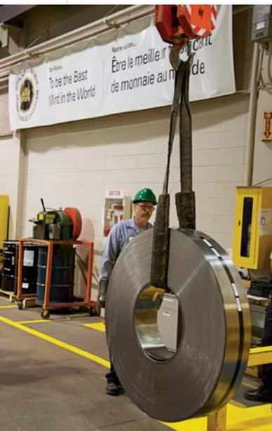
L'édifice de la Monnaie à Winnipeg présente une façade brillante (À DROITE). Mais son intérieur est animé par le bruit et la force brutale. La création d'un huard débute avec le transport de bobines d'acier par un pont roulant de 5 tonnes (À GAUCHE). Chaque bobine pèse 1 500 kilogrammes et est acheminée vers une poinçonneuse.
