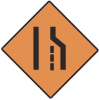
Carril cerrado por obras viales. Obedezca el límite de velocidad e incorpórese con el tráfico en el carril abierto.
