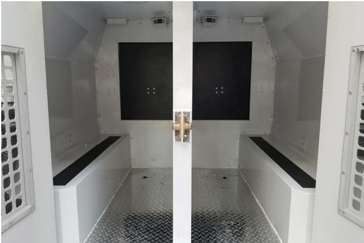
Compartiment pour le transport des détenus dans le prototype de véhicule d'escorte de sécurité du SCC.
